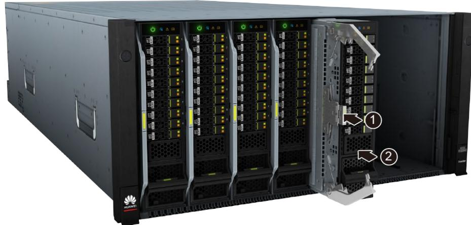
2. 当节点推入系统插框后，同时复位节点扳手，直至听到“咔”一声，此时节点完全锁定到系统插框。
