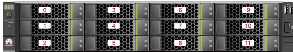
图A-28 后置硬盘槽位号
