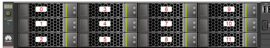
图A-20 后置硬盘槽位号
