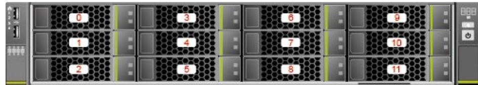
图A-51 后置硬盘槽位号
