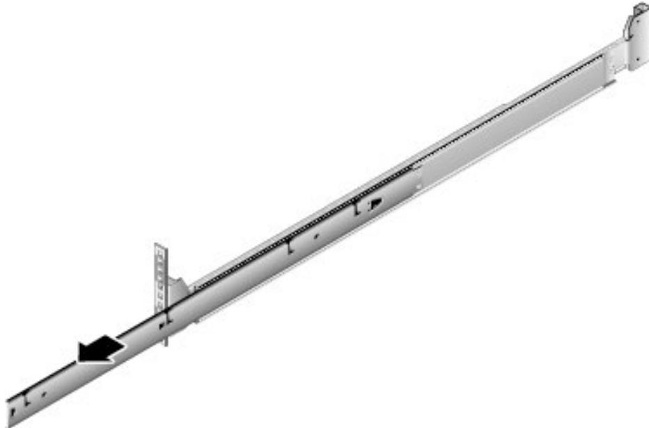
2. 至少两人从节点两侧水平抬起，将节点上的固定钉对准内轨的固定孔位，沿箭头方向推动，直到听见“咔”的一声，确保卡扣弹起完全挡住挂钉，使节点固定到内轨上，如图 9-68 所示。
