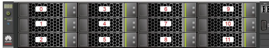
图A-22 后置硬盘槽位号
