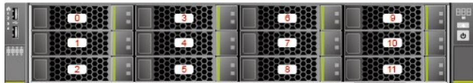
图A-45 后置硬盘槽位号
