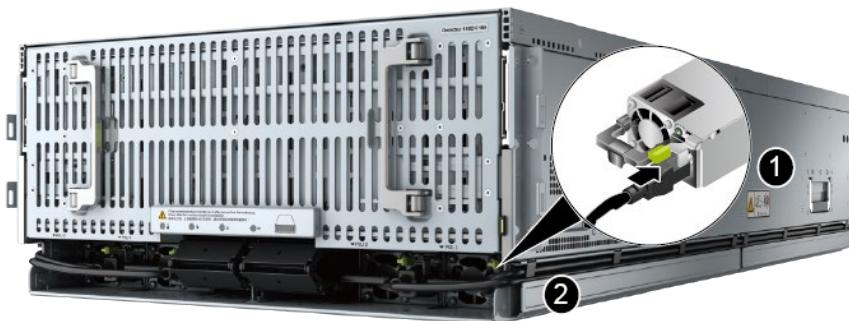
2. 使用魔术贴将电源线固定在电源模块的拉手上。
