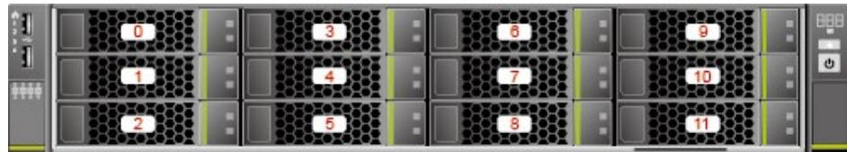
图A-47 后置硬盘槽位号
