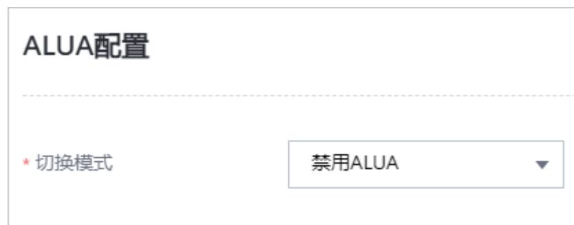
步骤 4 设置主机的切换模式和路径类型。系统支持以下两种路径切换模式：“启用 ALUA”和“禁用 ALUA”。
