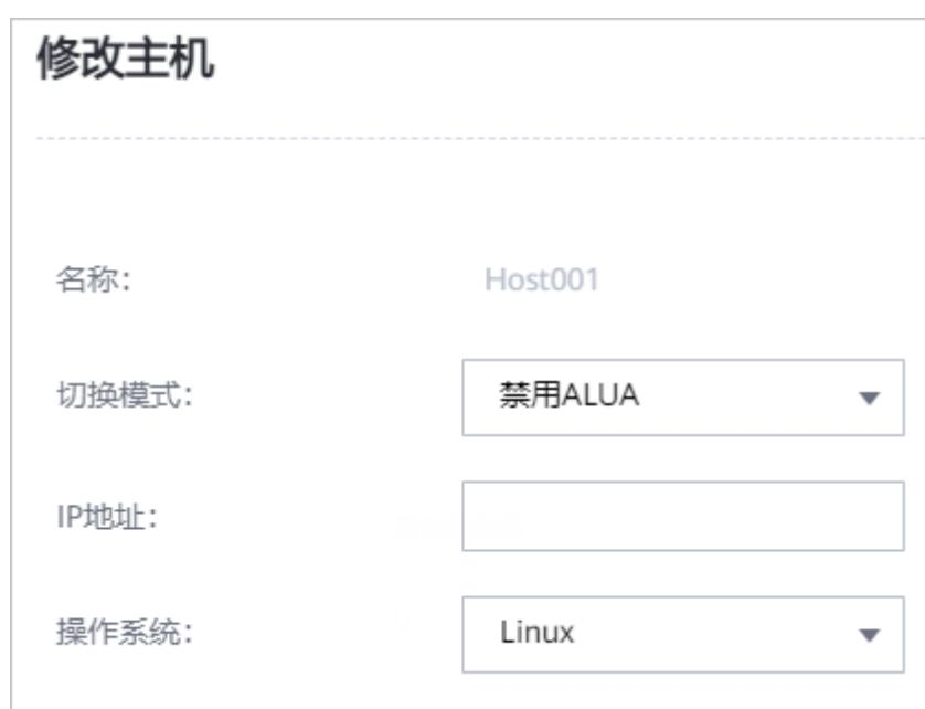
步骤 4 设置路径切换的模式，系统支持以下两种模式：“禁用 ALUA”和“启用 ALUA”。
