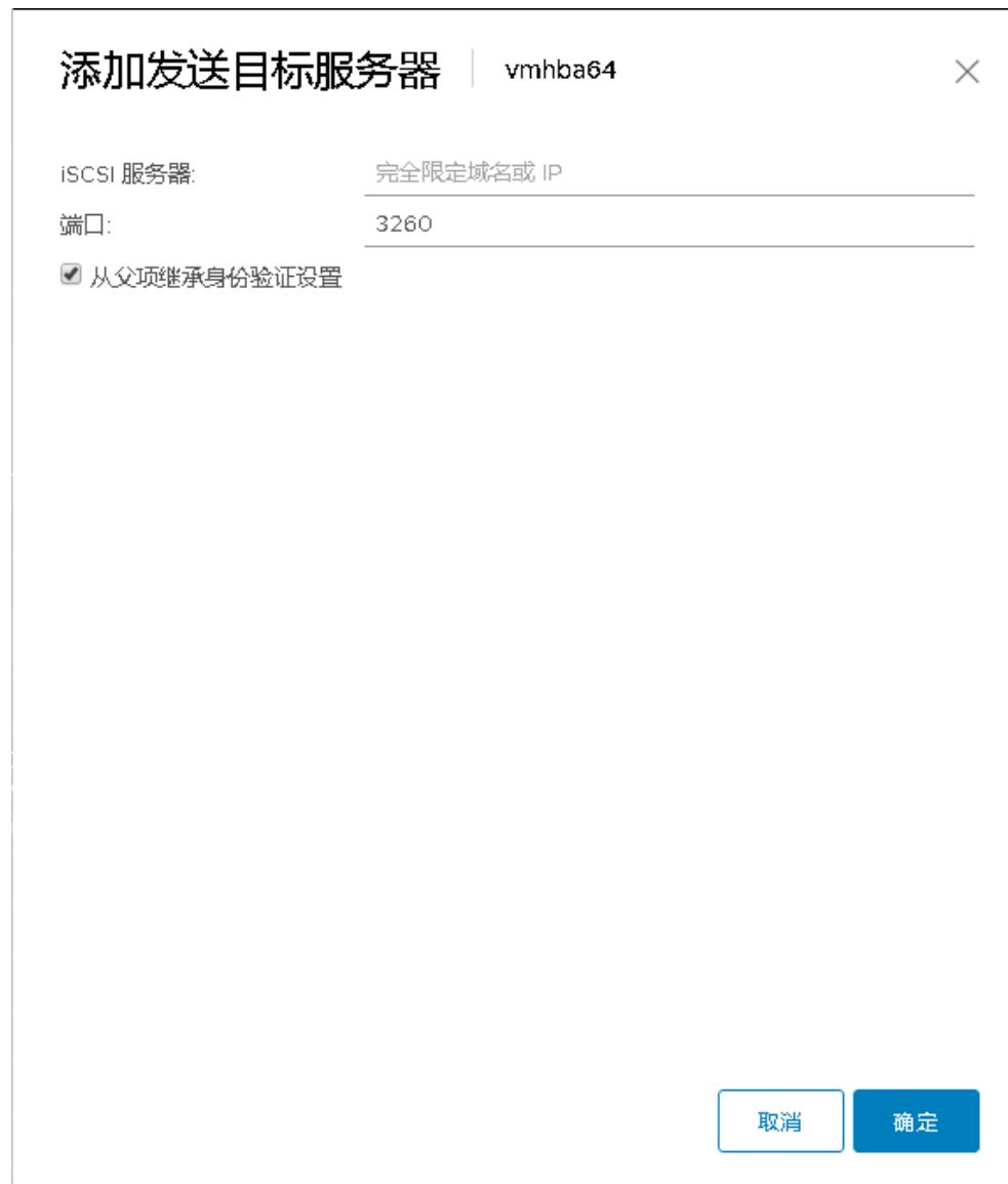
步骤 6 在“iSCSI 服务器”区域输入启动了 iSCSI 服务的节点（存储节点或 CVM）的 iSCSI IP 地址，“端口”字段保持“3260”不变。
