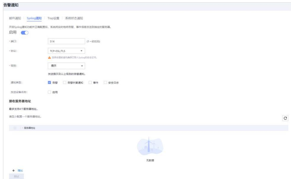
步骤 3 设置 Syslog 服务器接收告警的地址、发送告警的级别及通知类型。
